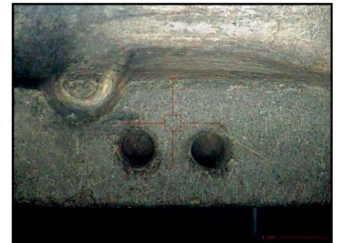
Ryc. 13. Obszar pomiaru (05) w części formy ML/A 1118/3 bez kontaktu z ciekłym stopem, pow. 1x.
