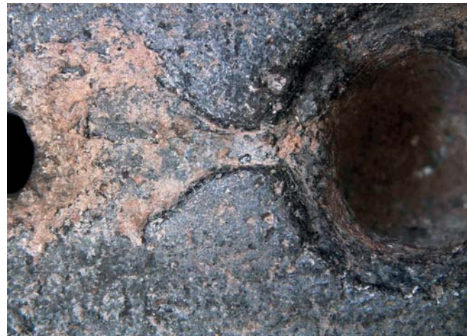
Ryc. 18. Obraz makroskopowy. Przerwana wnęka formy ML/A 1081/1a, w kierunku sworzni centrującej, pow. 7x.
