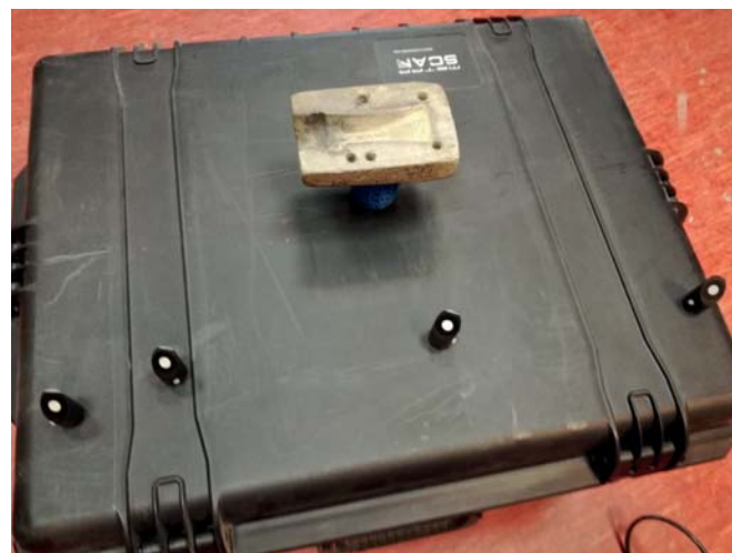
Ryc. 32. Stanowisko pomiarowe: po lewej – podczas digitalizacji formy do odlewania siekierek, z widocznym rozmieszczeniem markerów pozycjonujących, po prawej – podczas digitalizacji połówki formy do odlewania brzytew.
