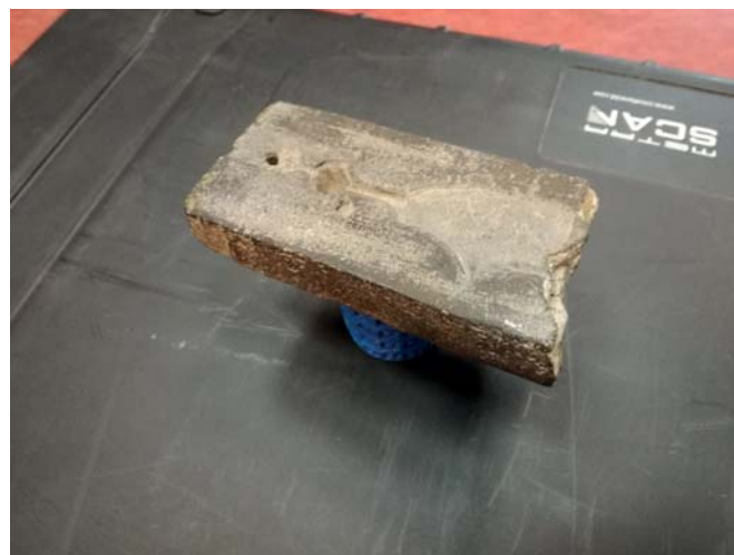
Ryc. 32. Stanowisko pomiarowe: po lewej – podczas digitalizacji formy do odlewania siekierek, z widocznym rozmieszczeniem markerów pozycjonujących, po prawej – podczas digitalizacji połówki formy do odlewania brzytew.
